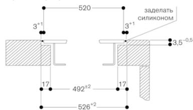
При монтаже с крышкой прибора или выравнивающей планкой,
