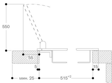
Монтаж с крышкой прибора / компенсационной планкой,
